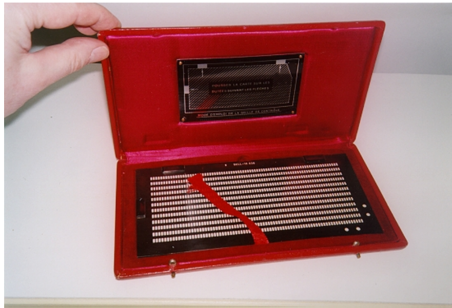
Abbildung 19.1.: Lochkartenlehre zur Überprüfung der Maßhaltigkeit
