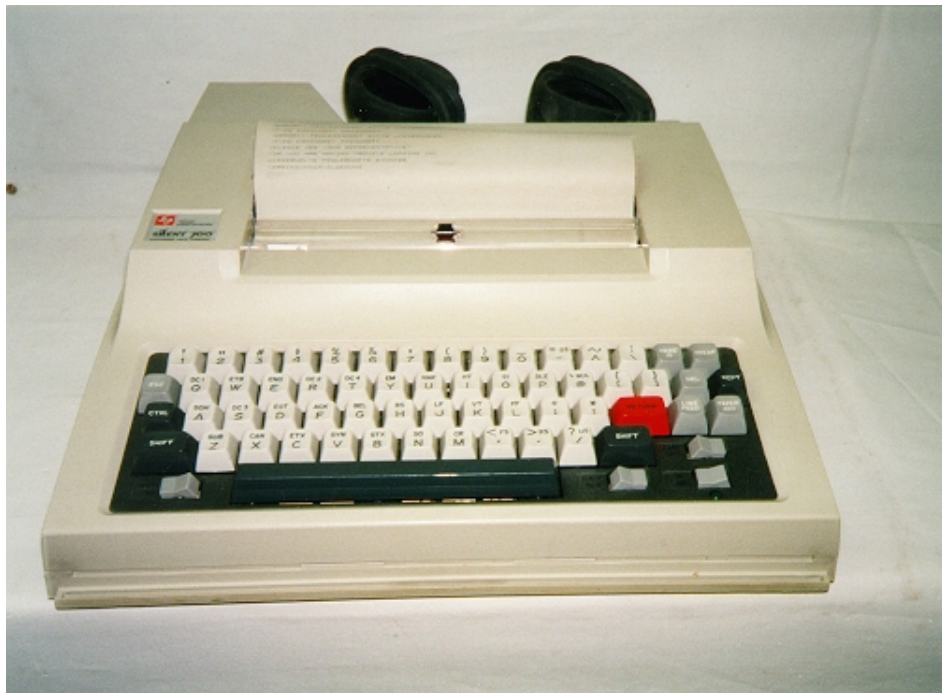
Abbildung 18.1.: Silent 700 Telefon-Terminal, hinten Gummimuscheln für den Hörer
